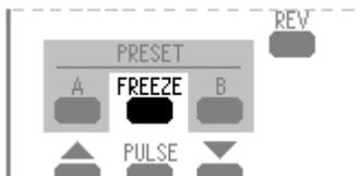
Das Drücken der roten FREEZE-Taste stoppt einen Überblendvorgang ab. Erneutes Drücken von FREEZE setzt den Überblendvorgang fort. Während dieser Funktion ist beim entsprechenden Projektor ein „F“ im Display zu sehen. FREEZE kann auch durch einen Überblend-Befehl aufgehoben werden. Die Überblendung wird dabei rückgeführt!
