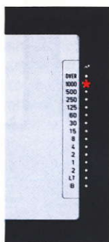
Zeitanzeige bei Verwendung der Meßwert- speicherung
