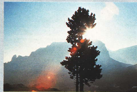
Interne Reflexionen (Geisterbilder) eines Objektives mit herkömmlicher Vergütung
