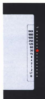
Zeitanzeige bei manueller Einstellung (korrekte Einstellung)
