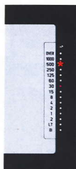
Zeitanzeige bei manueller Einstellung (zeigt gewählte und gemessene Zeit)
