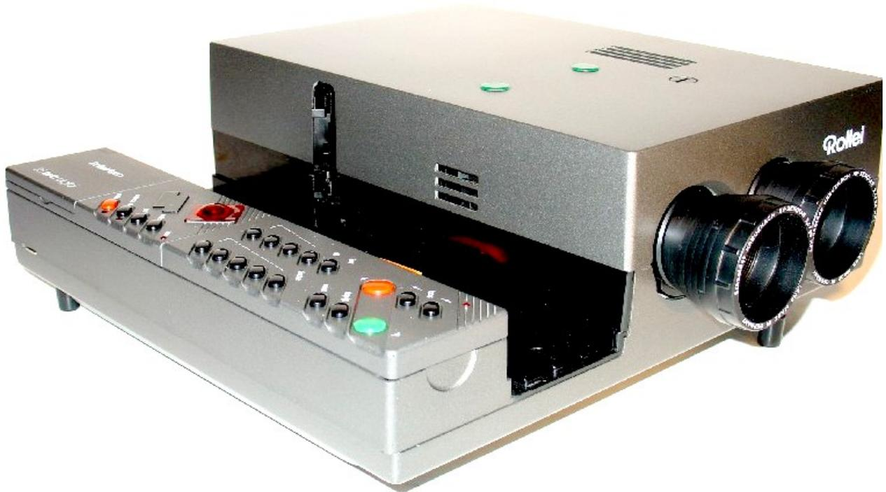
Der Rollei 35 twin digital/P ist der Vorgänger der MSC Serie. Er wurde von 1989 bis 1994 hergestellt. Damals sehr fortschrittlich auch mit Verbindung zum PC konnte man die „P“ Modelle mit der seriellen Schnittstele über das DOS oder WIN 95 Betriebssystem fernsteuern. Zu der Zeit wurde die „Dia-Edit“ Software von Rollei erfunden. Diese wie auch die beiden Vorgängermodelle P3801(Foto links) er wurde von
